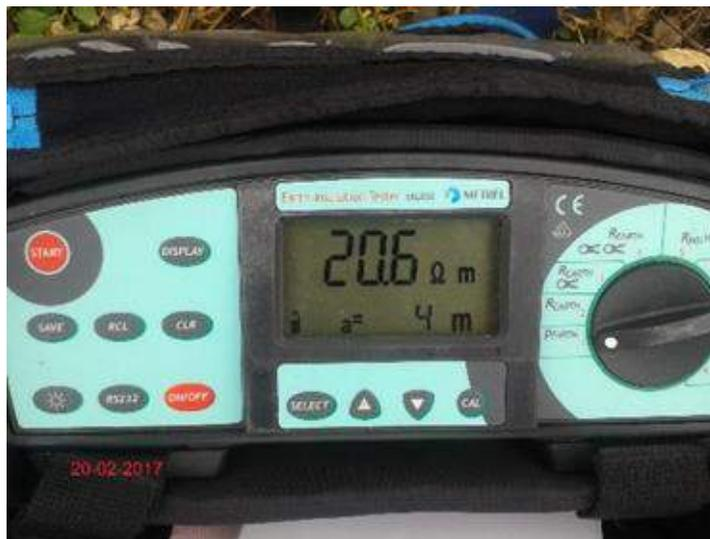
Figura N°8. Medida de Resistividad de Terreno.
